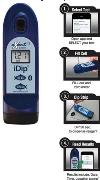
Рис. 2.8. Загальний вигляд та характеристики фотометра eXact iDip (сформовано автором за даними [177])
