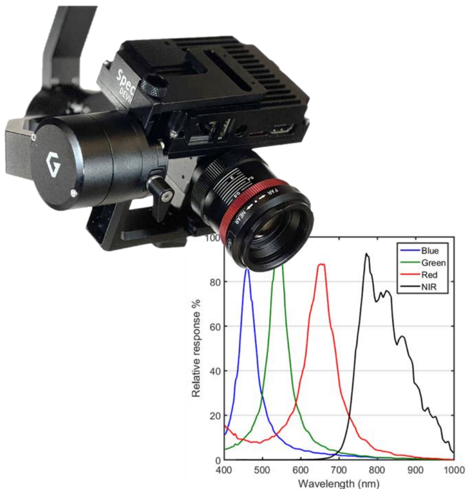
Рис.1.16: Камера з каналами RGB + NIR, але з класичною RGB секцією (Spectral Devices). Джерело: https://spectraldevices.com/cdn/shop/products/msd-rgbn-1-a.png
