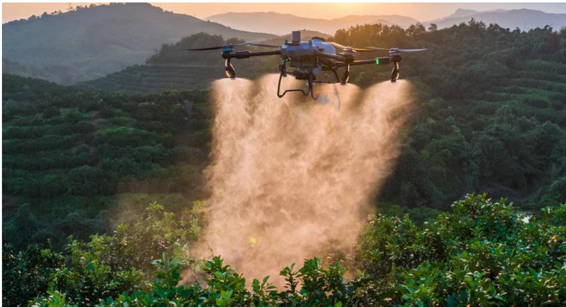
Рис 1.9. БПЛА-обприскувач TALOS T60X. Джерело: [13]
