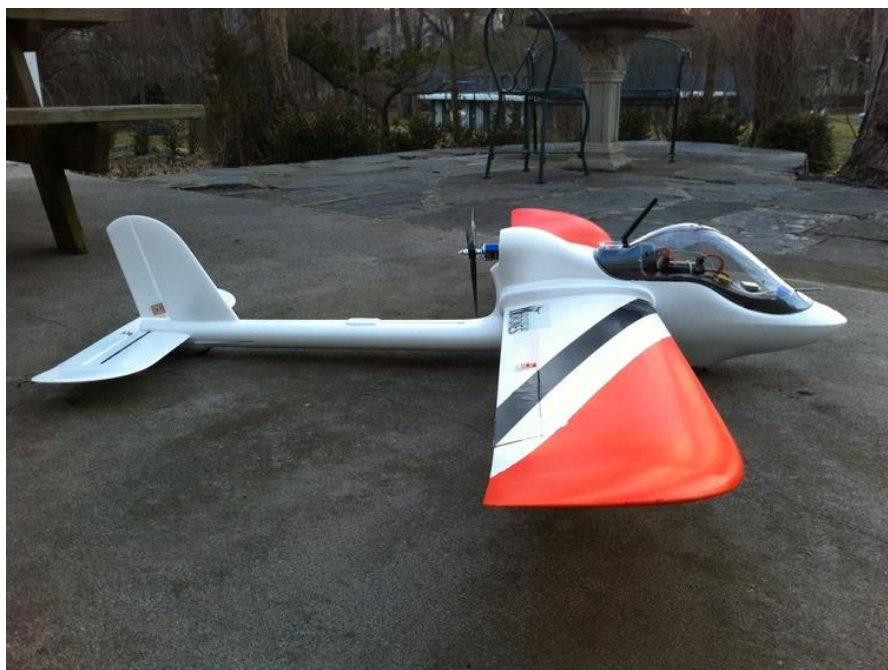
Рис 1.5. Планер: Finwing Universeye Penguin. Джерело: [9]
