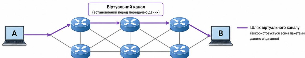
Рисунок 1.3 – Типи комутації у глобальних мережах
