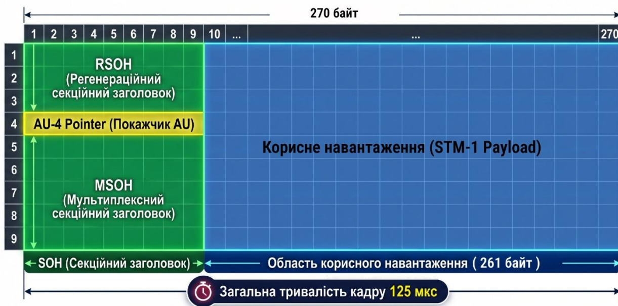
Рисунок 2.1 – Структура кадру STM-1 (SDH)
