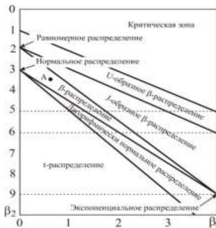
Рис. 5.46. Діаграма Пірсона. Точкою А відмічено співвідношення показників \beta_1 (відношення асиметрії розподілу до степеня розсіювання) і \beta_2 (відносний показник ексцесу) для сукупності ординат профілю поверхні покриття, наплавленого дротом ПП-Нп-30Х4Г2М, обробленим інструментом з ПНТМ киборит.
