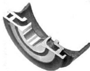
Рис. 6.1. Торець і посадочний отвір направляючого апарату погрузного відцентрового насоса (розріз деталі), відновлені методом газополуменевого напилення порошком ПР-Н80Х13С2Р ( HV = 5,3 \dots 6,9 ГПа)
