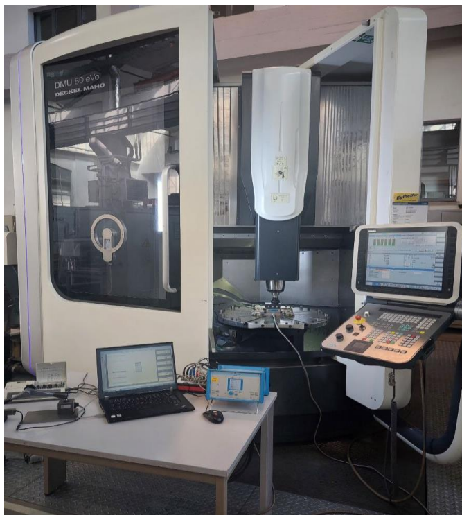
Рис. 3.7. Спеціальний апаратний комплекс для вимірювання складових сили різання при фінішній обробці
