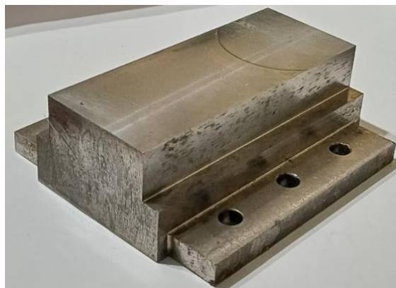
Рис. 3.5. Заготовка для досліджень сил різання під час фінішного торцевого фрезерування ЧВГ [80]
