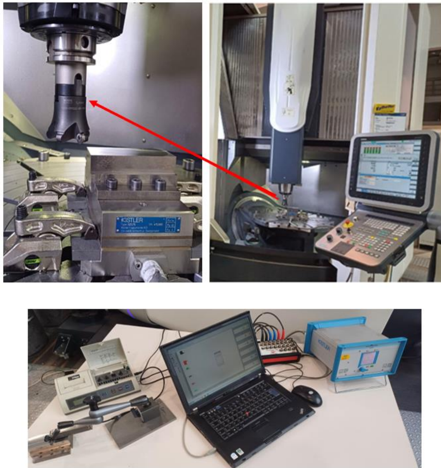
Рис. 3.6. Верстатно-апаратний комплекс для визначення сил різання під час фінішного торцевого фрезерування ЧВГ інструментами з КНБ та НК
