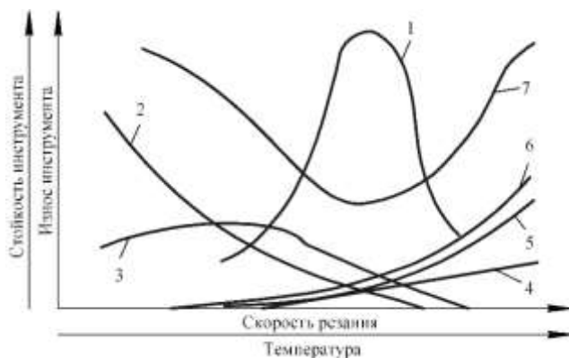
Рис. 4.19. Умовна діаграма «стійкість інструменту-швидкість різання» (1) і умовна діаграма областей механізмів зношування інструменту: 2 – абразивний знос; 3 – адгезійний знос; 4 – дифузійний знос; 5 – знос за рахунок евтектичного плавлення; 6 – окислювальний знос; 7 – загальний знос
