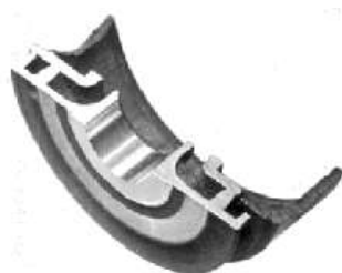
Рис. 6.1. Торець і посадочний отвір направляючого апарату погрузного відцентрового насоса (розріз деталі), відновлені методом газополуменового напилення порошком ПР-Н80Х13С2Р ( HV = 5,3 \dots 6,9 ГПа)
