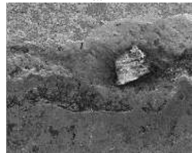
Рис. 4.29. Зношені ділянки інструменту з ПНТМ киборит після точіння напилених покриттів з аморфно-кристалічною структурою: а ( \times 150 ); б ( \times 500 ); в ( \times 320 ); г ( \times 550 ); д (те ж, в режимі фазового контрасту) – газополуменеве покриття порошковим дротом Fe_{80}B_{20} ( v = 1,7 м/с, S = 0,05 мм/об, t = 0,2 мм, h_3 = 0,25 мм, \gamma = -10^\circ ); е ( \times 200 ) – газополуменеве покриття порошком Fe_{78}Si_{12}B_{10} ( v = 1,7 м/с, S = 0,05 мм/об, t = 0,2 мм, h_3 = 0,15 мм; \gamma = -20^\circ ); ж ( \times 100 ); з (те ж, в режимі фазового контрасту); і ( \times 800 ); к ( \times 40 , \gamma = -10^\circ , \alpha = 20^\circ , v = 2,7 м/с); л ( \times 100 , \gamma = -20^\circ ) – електродугове покриття порошковим дротом Fe_{79}Cr_{16}B_5 ( v = 2 м/с, S = 0,05 мм/об, t = 0,2 мм, h_3 = 0,4 мм, \gamma = -10^\circ ); м ( \times 550 ); н (те ж, в режимі фазового контрасту); о ( \times 150 , v = 0,7 м/с) – газополуменеве покриття порошком Fe_{79}Cr_{16}B_5 ( v = 2 м/с, S = 0,05 мм/об, t = 0,2 мм, h_3 = 0,4 мм, \gamma = -10^\circ )
