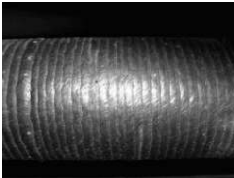
Рис. 1.3. Зовнішній вигляд зразка з покриттям, сформованим електродуговим наплавленням дротом
