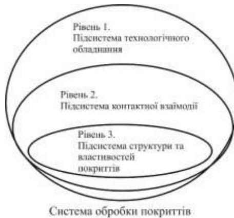
Рис. 1.18. Схема системи обробки покриттів
