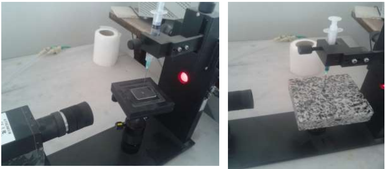
Рис. 3.3. Вимірювання кута розтікання на поверхні Покостівського гранодіориту тензіометром “KSV CAM100”
