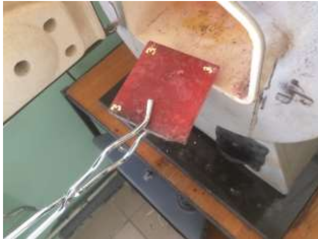
Рис. 4.3. Вигляд зразка лабрадориту при нагріванні до 900 °С
