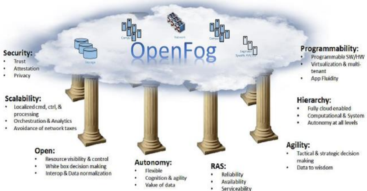
Рис. 4.6. Опори (стовпи) OpenFog RA
