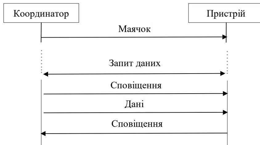
Рис. 3.2. Процес передачі даних від координатора до пристрою
