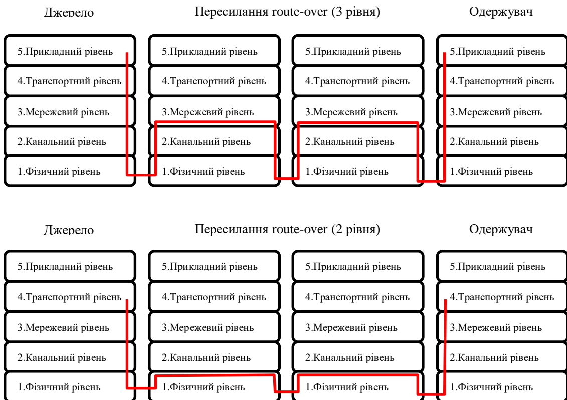
Рис. 3.13. Пересилання пакетів mesh-under та route-over
