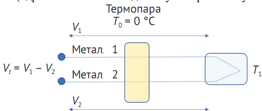
Рис. 2.13. Блок-схема вимірювання температури за допомогою термопари [1]
