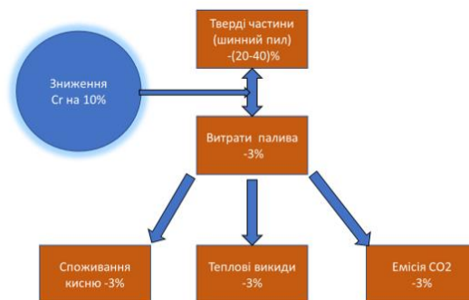
Рис.2. Вплив зниження коефіцієнту опору кочення C_r автомобільних шин на їх зношуваність, витрати палива, споживання кисню, викидів теплоти, CO_2 і шинного пилу.
