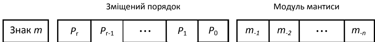
Рис. 2.4. Формат числа з ПК із зміщеним порядком
