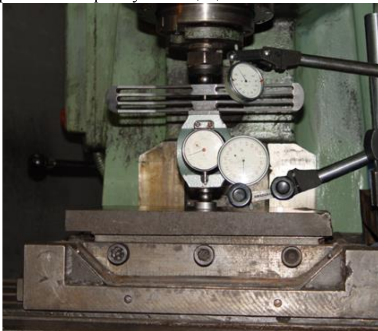
Рисунок 3.16 – Схема вимірювання жорсткості в осьовому напрямку
