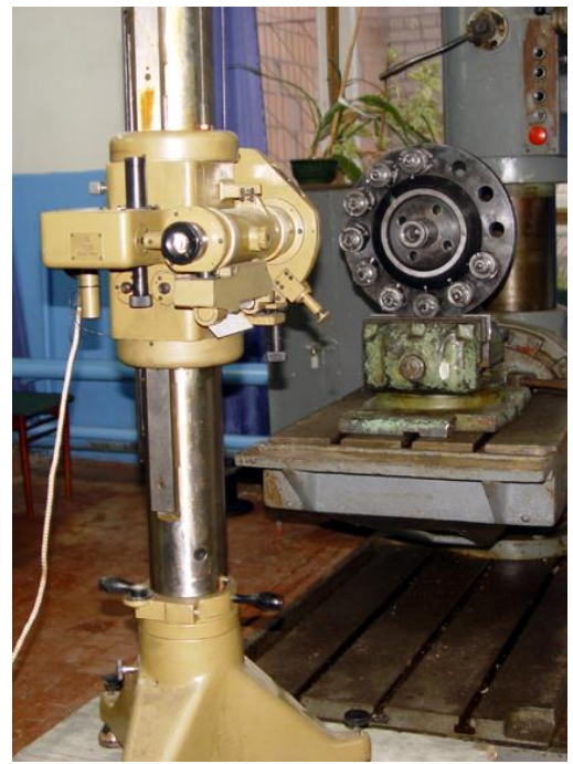
Рисунок 4.11 – Загальний вигляд експериментальної торцевої фрези з двоспиральною–шестиступеневою схемою різання за логарифмічною спіраллю
