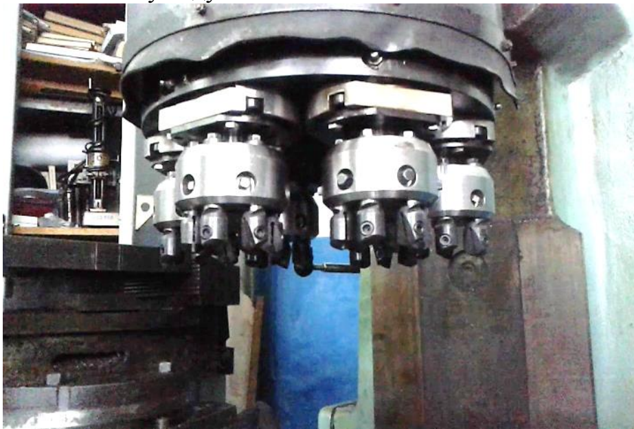
Рисунок 4.50 – Встановлення фрези у шпинделі вертикально-фрезерного верстата 6P12
