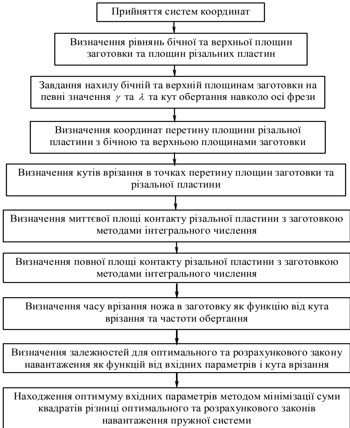
Рисунок 2.22 – Алгоритм розв’язання задачі оптимізації параметрів інструменту та режимів обробки за критерієм мінімуму коефіцієнту динамічності
