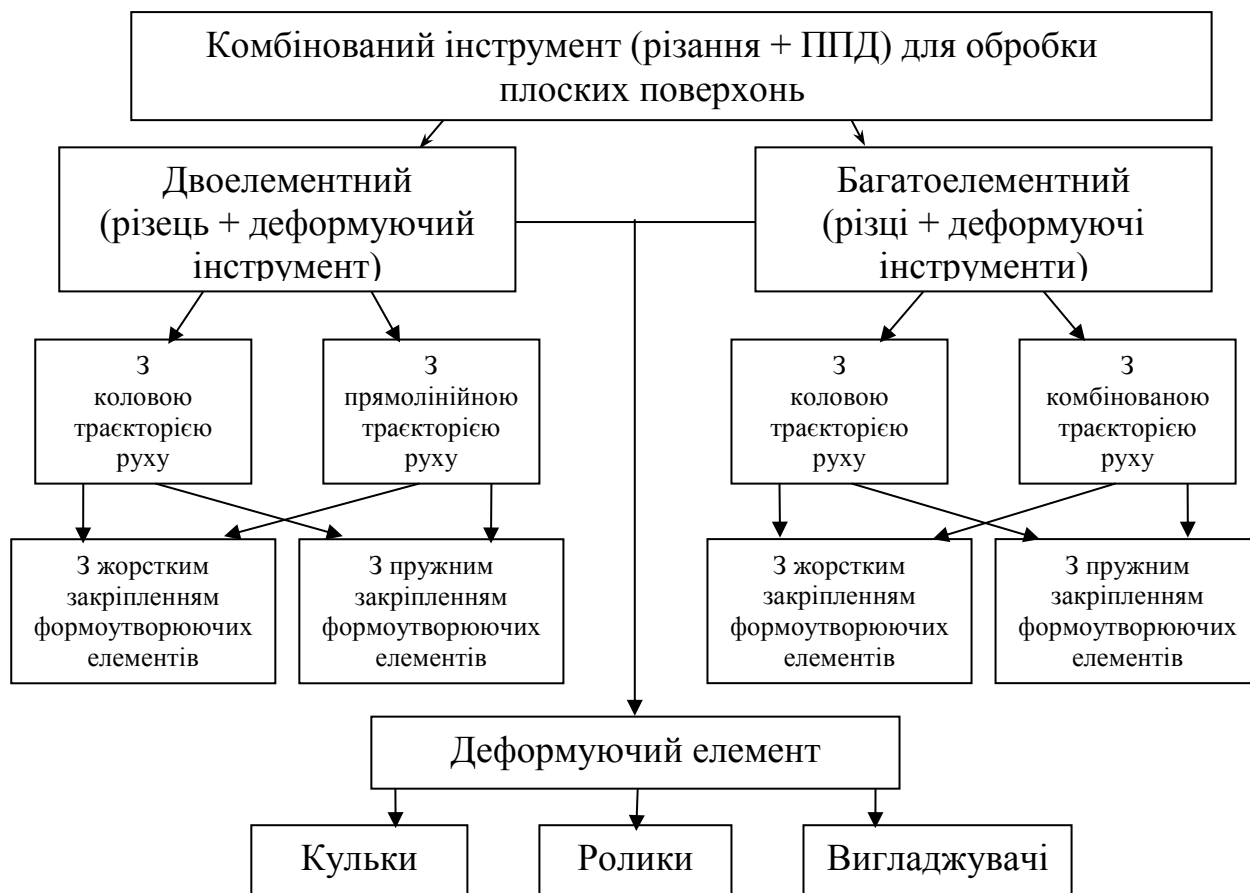
Рисунок 1.12 – Конструктивні варіанти комбінованого інструменту (різання і поверхневе пластичне деформування) для обробки плоских поверхонь
