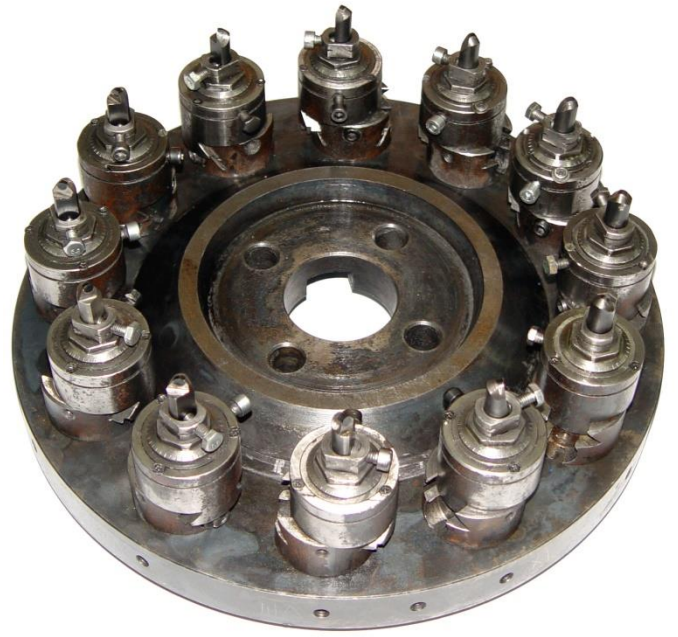
Рисунок 4.11 – Загальний вигляд експериментальної торцевої фрези з двоспиральною–шестиступеневою схемою різання за логарифмічною спіраллю
