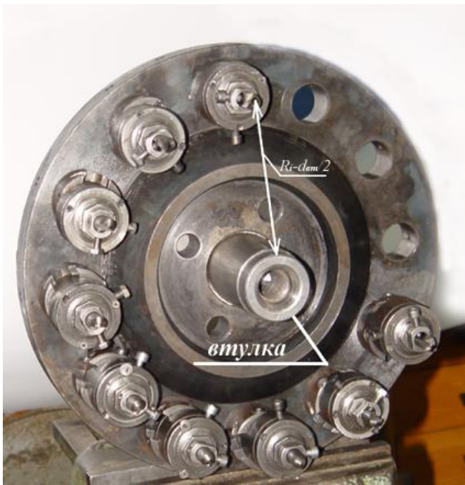
Рисунок 4.11 – Загальний вигляд експериментальної торцевої фрези з двоспиральною–шестиступеневою схемою різання за логарифмічною спіраллю
