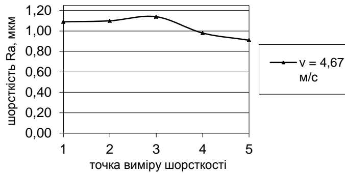
Рисунок 3.58 – Шорсткість обробленої поверхні R_a в напрямку перпендикулярному до вектора подачі заготовки
