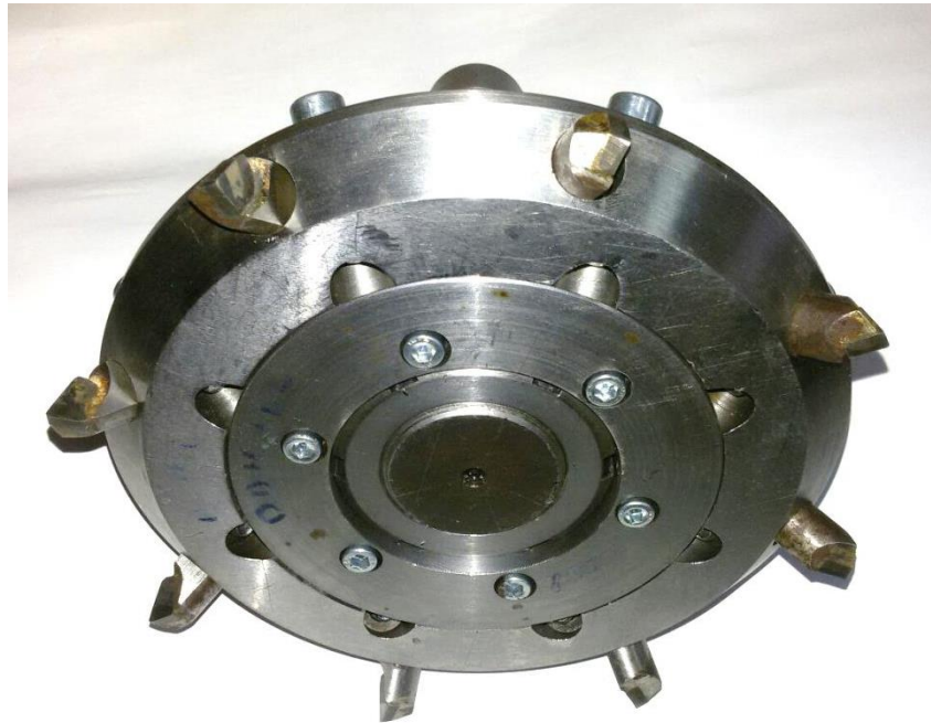
Рисунок 4.51 – Розроблена конструкція торцевого інструменту для обробки плоских поверхонь деталей з нежорстких заготовок
