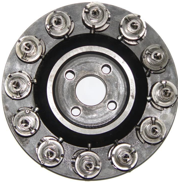
Рисунок 4.11 – Загальний вигляд експериментальної торцевої фрези з двоспиральною–шестиступеневою схемою різання за логарифмічною спіраллю
