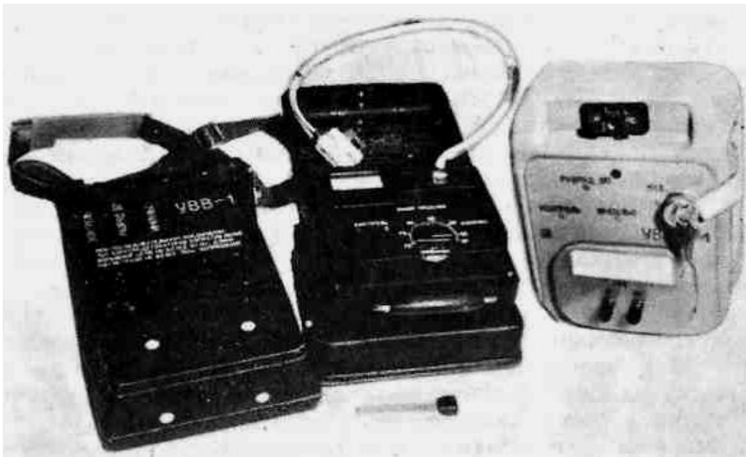
Рис. 7.2. Нова вітчизняна безпечна система електропідривання для шахт і рудників, безпечних за газом і пилом, та імпульсної обробки матеріалів
