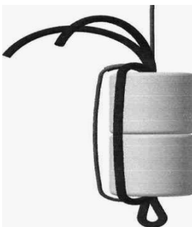
Рис. 4.7. Схема з'єднання пристрою УНС-С з шашкою Т- 400М
