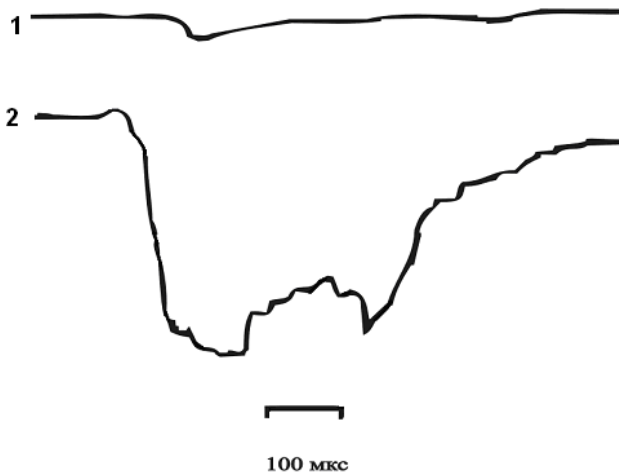
Рис. 5.6. Осцилограми, що фіксують процес деформації трубчастого хвилеводу, що детонує:
