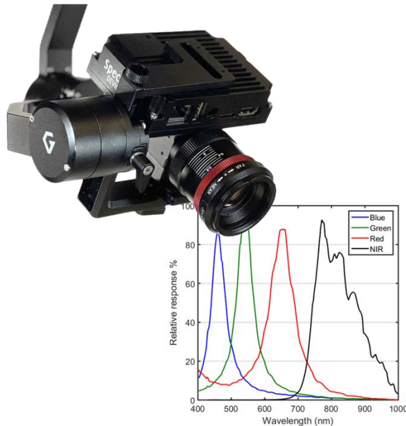
Фото: Камера з каналами RGB + NIR, але з класичною RGB секцією (Spectral Devices)
