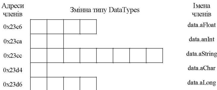
Рисунок 9.1 - Зберігання елементів структури у пам'яті
