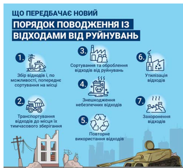
Рис. 1. Порядок поводження із відходами від руйнувань [9]
