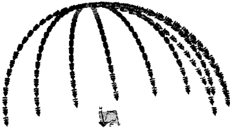
Рис. 1. Розташування аналізаторів поля по сфері великого радіусу
