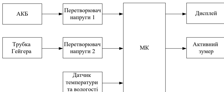
Рисунок 1 – Структурна схема комп’ютеризованої системи вимірювання вмісту радіації в навколишньому середовищі
