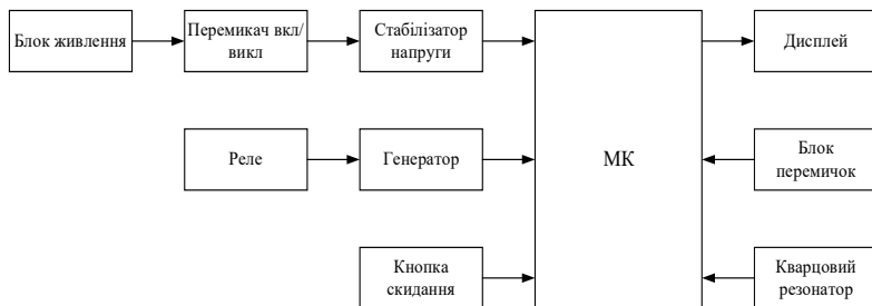
Рисунок 1 – Структурна схема комп'ютеризованої системи вимірювання ємності та індуктивності компонентів електронних схем
