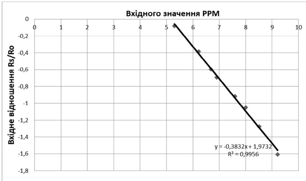
Рис. 5.6. Графік відношення вхідного значення PPM до вхідного відношення Rs/Ro датчика MQ-5
