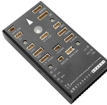
Рис. 3.5. Польотний контролер Pixhawk 2.4.5
