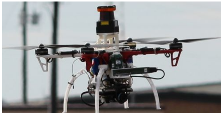
Рис. 5.13. Приклад розміщення датчиків над променями дрона
