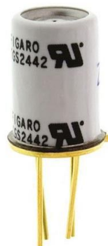
Рис. 1.3. Напівпровідниковий датчик чадного газу TGS2442
