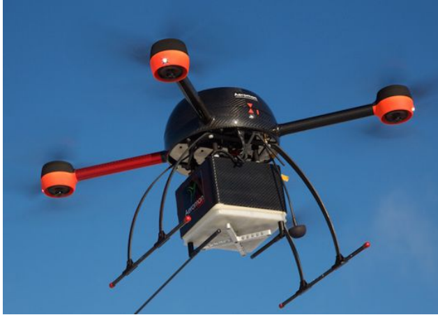
Рис. 5.12. Приклад розміщення датчиків під дном БПЛА
