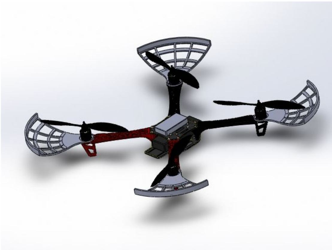
Рис. 5.10. Повномасштабна 3d модель квадрокоптера з встановленим захисним елементом
