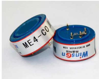
Рис. 1.1. Електрохімічний датчик чадного газу «ME4-CO» для промислового використання
