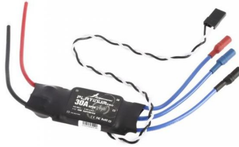
Рис. 3.2. Регулятор ходу (ESC) HobbyWing Platinum Pro 30A 2S-6S Opto
