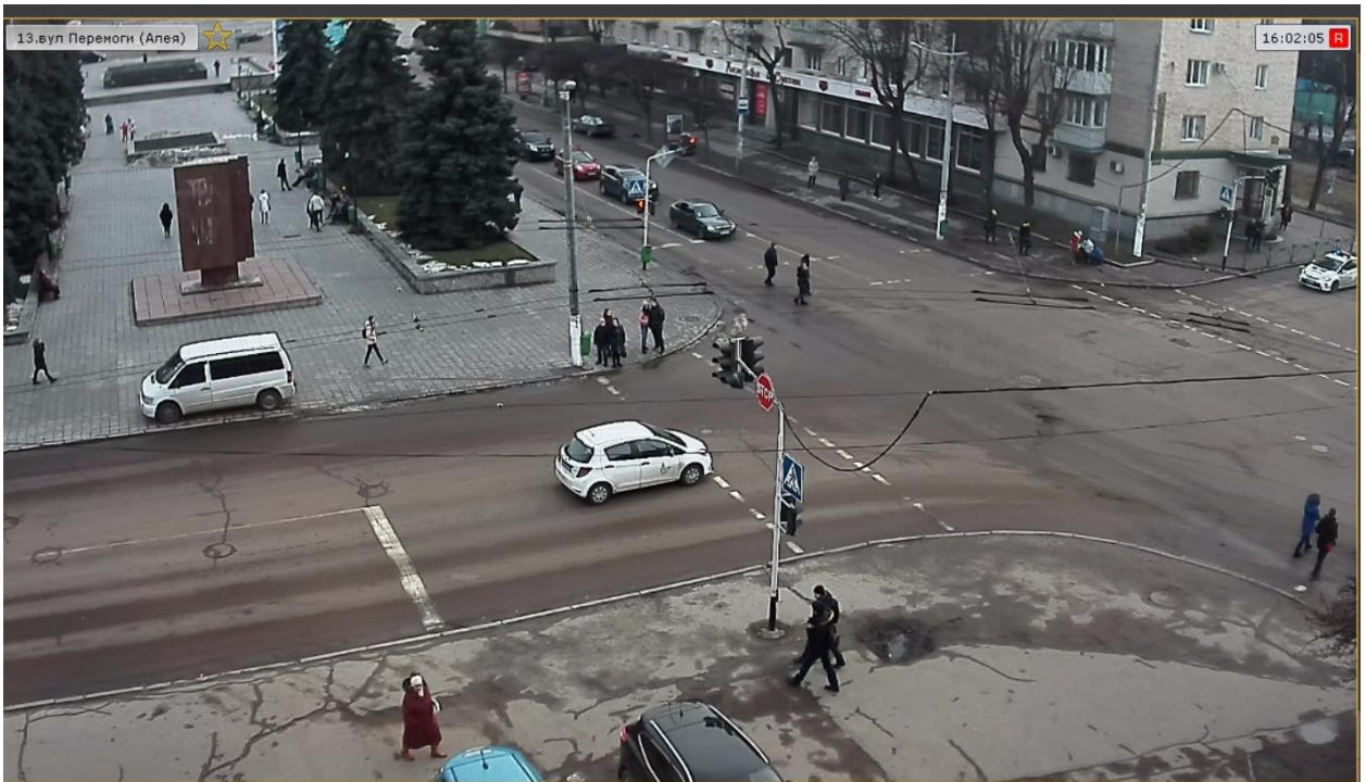
Рисунок 4.3.22 – Фрагмент відеозапису для обстеження ймовірності виїзду ТЗ за стоп-лінію при жовтому сигналі світлофора
