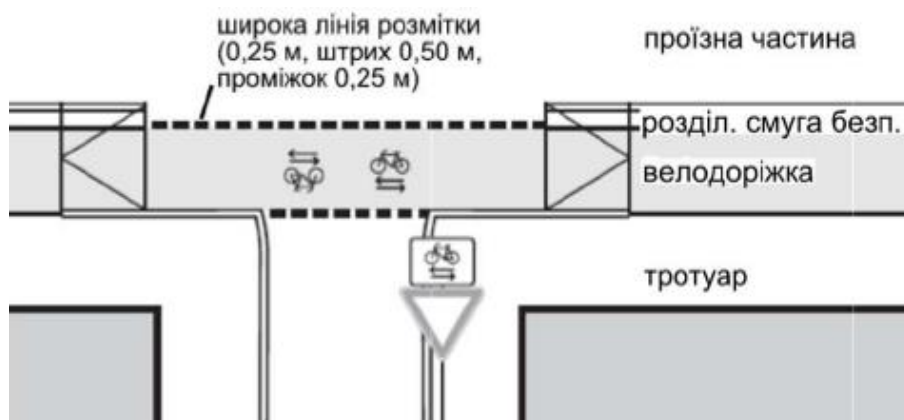
Рисунок 4.2.8 – Велосипедний переїзд на примиканні (Джерело: [21])
