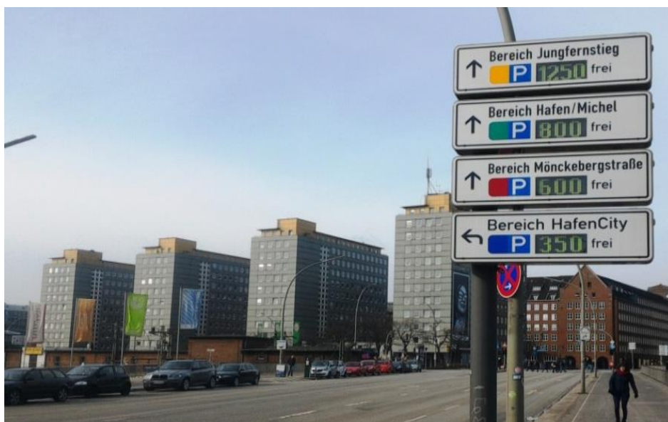
Рисунок 4.2.52 – Табло з інформацією про кількість вільних місць на парковках м. Гамбурга (Німеччина)
