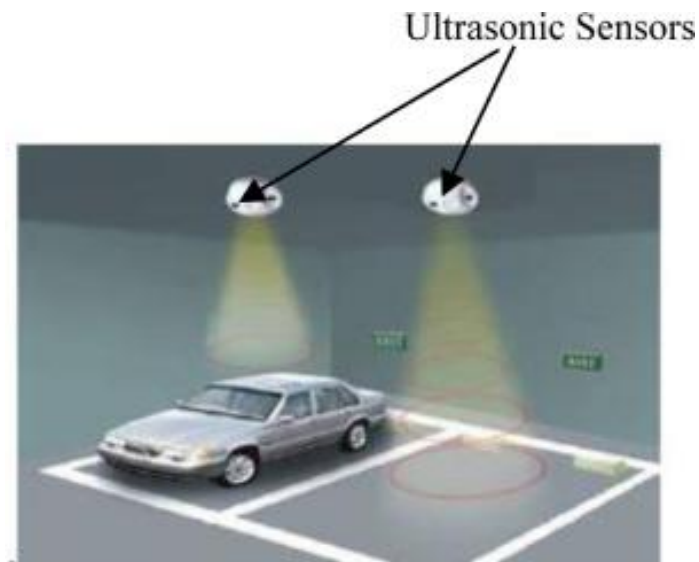
Рисунок 3.1 – Система ультразвукових датчиків для визначення зайнятості паркувального місця [47]
