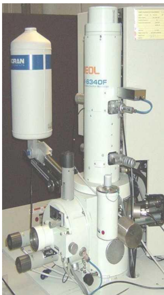
Рис. 2.8. Скануючий електронний мікроскоп і схематичне зображення потоку електронних променів: 1 – стійка; 2 – джерело електронів; 3 – електрони; 4 – катод; 5 – анод; 6 – оптична лінза; 7 – зразок; 8 – дифракційний об'єктив; 9 – проєкційний об'єктив; 10 – детектор
