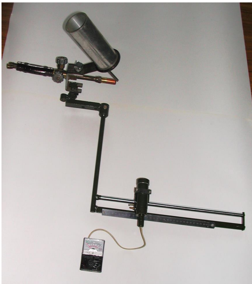
Рис. 3.7. Установа вимірювання потоку випромінювання полум'я пальника
