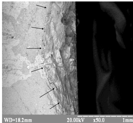
Рис. 4. Деформація в моделі з пластиною товщиною 2 мм
