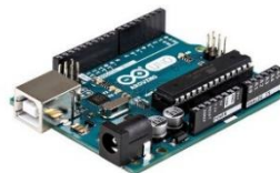
Рис. 1. Плата Arduino UNO R3 на мікроконтролері ATmega 328
