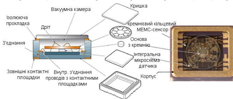
Рис. 1. Схема гіроскопічного акселерометра
