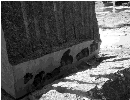
Рис 1. Утворення «сходинки» на бічній поверхні блоку лабрадориту при шпуровому способі пасирування.
