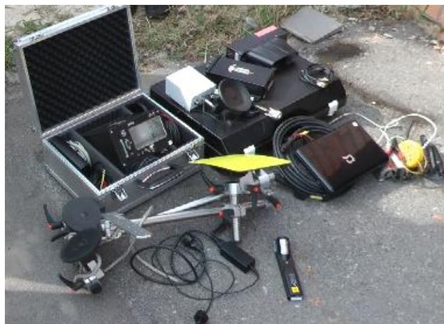
Рисунок – 8 Комплект обладнання для дослідження швидкісних характеристик ДТЗ
