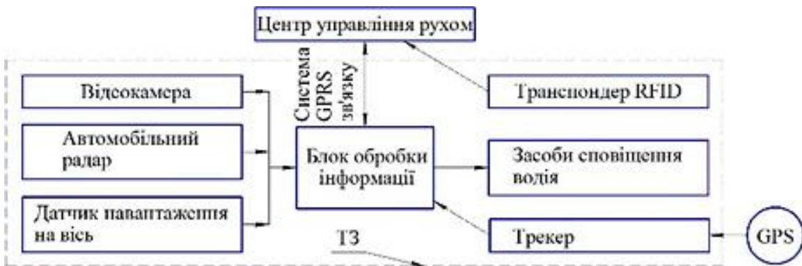
Рисунок 5 - Принципова функціональна схема компонентів ІТС маршрутного ДТЗ
