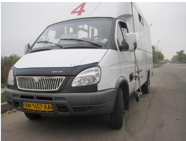
Рисунок - 7 Автомобіль Рута-20 Інва з обладнанням для дослідження тягово-швидкісних властивостей.
