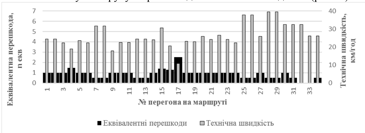
Рисунок 12 - Діаграма технічної швидкості з еквівалентними перешкодами руху міського автобуса Рута-20 Інва після впровадження компонентів ІТС
