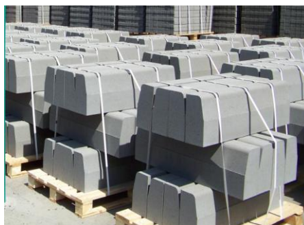
Рис. 5. Виготовлена будівельна продукція з відходів щебеню
