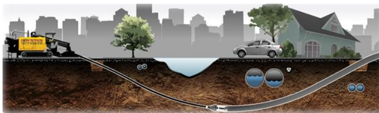
Рис. 1. Схема проведення горизонтально направлено буріння
