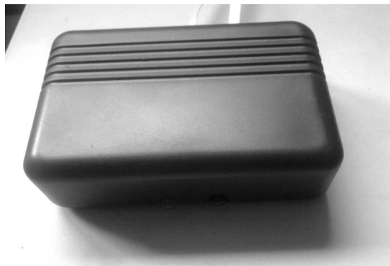
Рис. 4. Модуль програмно-апаратного комплексу для дослідження характеристик двигуна внутрішнього згоряння на основі МК ATmega16
