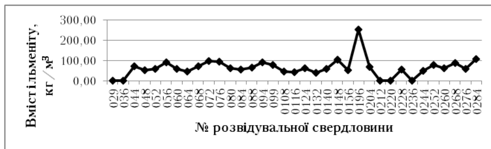
Рис. 1. Графік коливання вмісту ільменіту в рудному покладі по даним розвідувальних свердловин (розвідувальна лінія №84)
