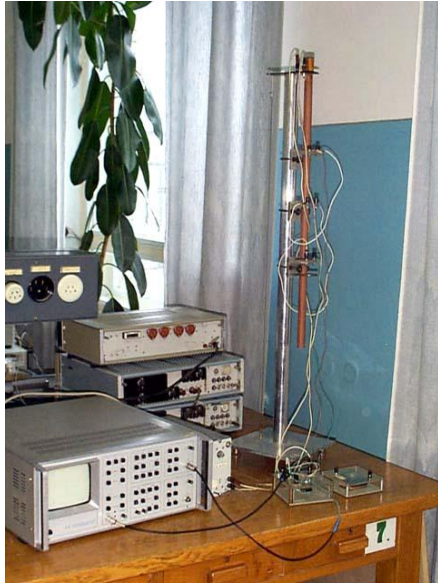
Рис. 1. Лабораторна установка балістичного лазерного гравіметра для експериментальних досліджень ПСТ
