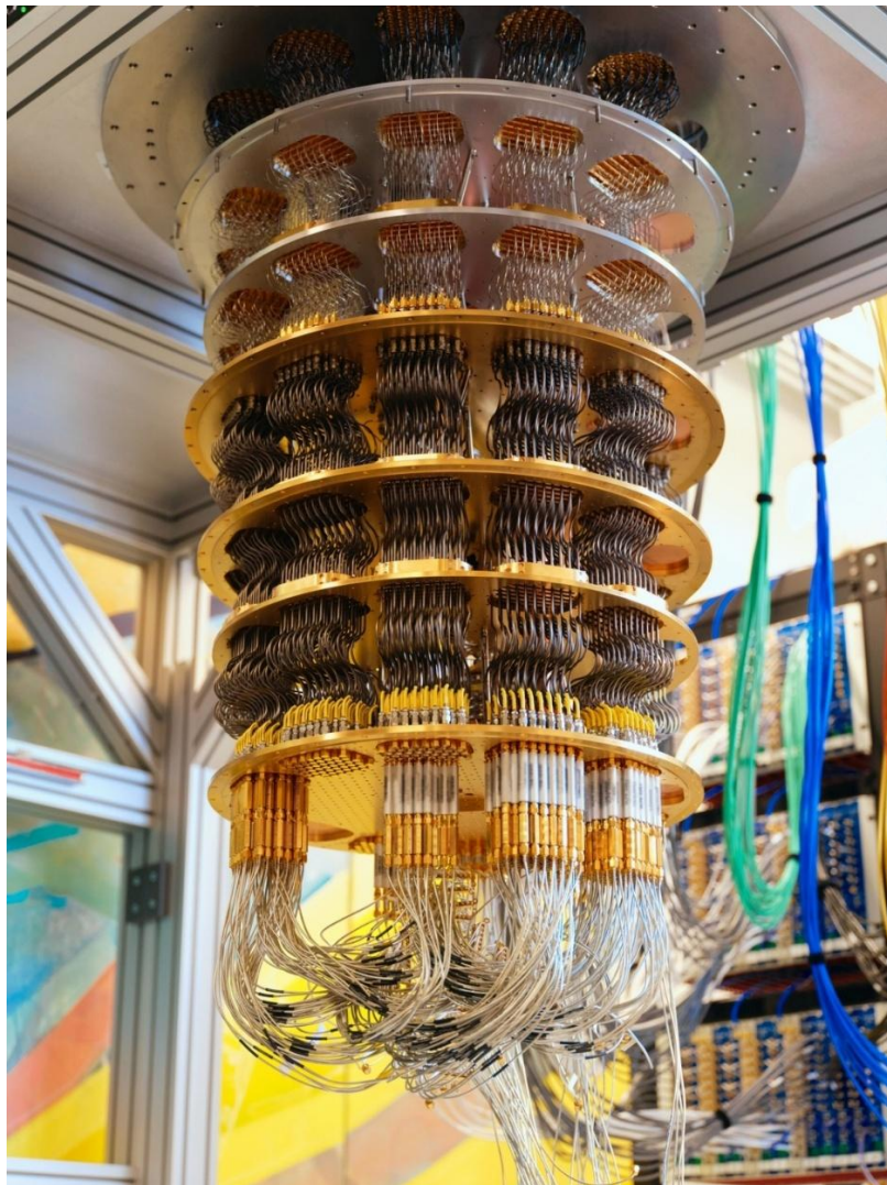
Рисунок 4.8 – Квантовий комп'ютер (процесор і система охолодження) [16]
