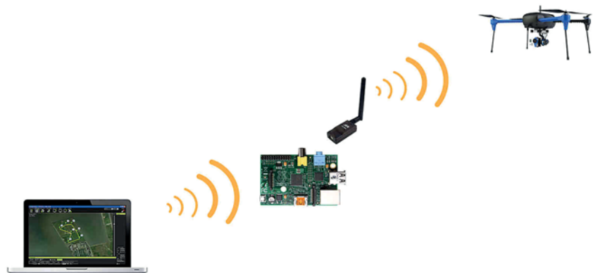
Рис. 4.9. Схема підключення Wi-Fi зв'язку для безпілотного апарата через Raspberry Pi [9]
