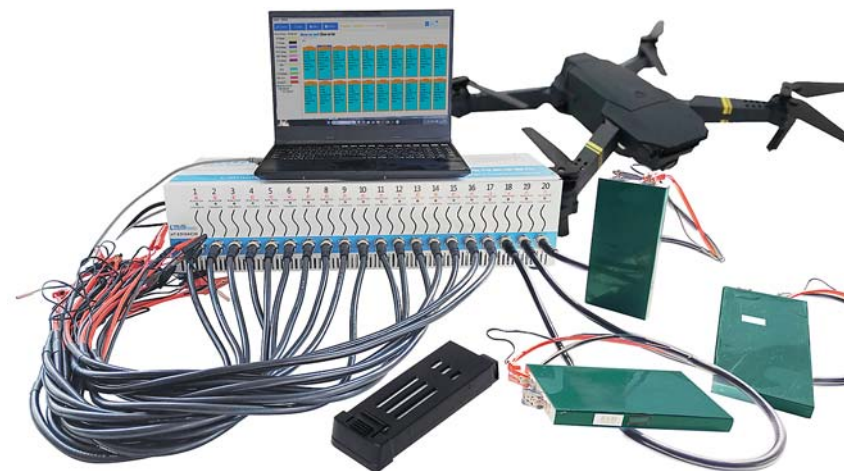
Рис. 4.4. Система Battery Analyzer для діагностики стану акумуляторів з візуалізацією інтерфейсу та підключенням тестованих батарей [5]
