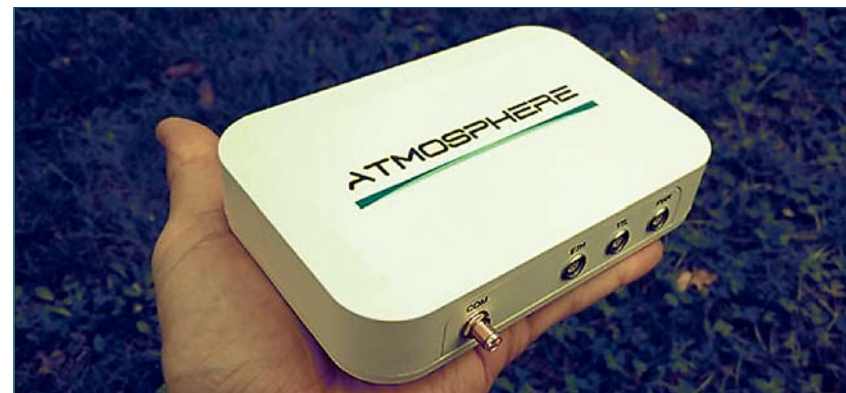
Рис. 4.10. PLANET 9523 UAV Terminal – Iridium Satellite Modem для безпілотних систем [9]
