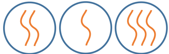
Рис. 3.1. Схематичне подання одного процесу з одним потоком (зліва), одного процесу з багатьма потоками (по центру) та трьох процесів з різною кількістю потоків (справа)
