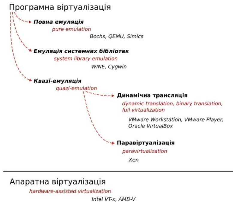
Рис. 9.4. Систематизація технологій віртуалізації за методом
