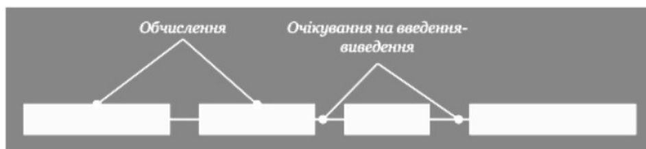
Рис. 4.1. Схематичне подання активності процесу, обмеженого швидкістю обчислень (CPU bound process) 16
