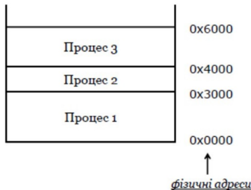
Рис. 5.2. Адресні простори процесів у разі роботи лише з фізичними адресами
