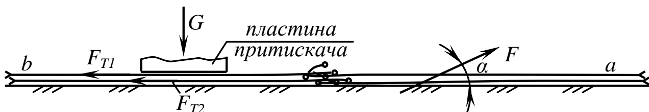
Рис. 2. Схема сил, що діють на стебла при виконанні обертання стрічки обертачем, обладнаним притискаючим пристроєм
