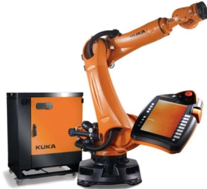
Рис. 1. Промисловий робот KUKA KR 100
