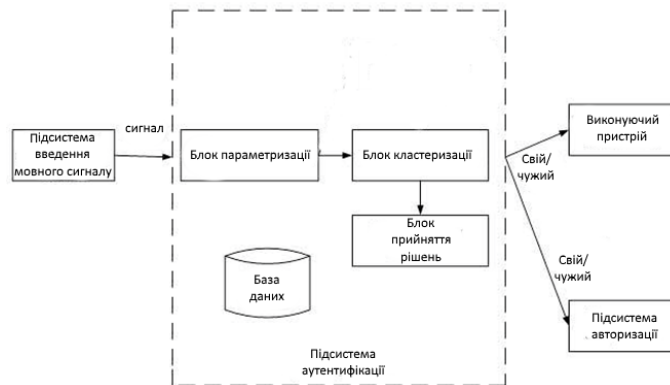
Рис. 1. Структура комп'ютеризованої системи контролю доступу
