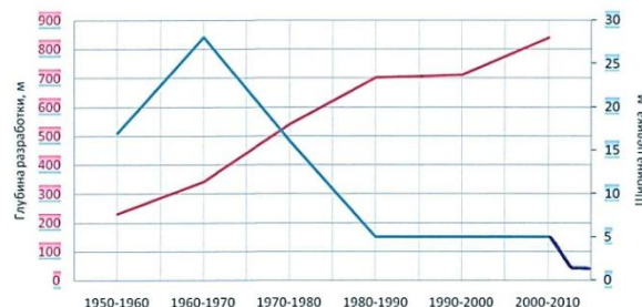
Рис. 2. Зависимость ширины целика от глубины ведения горных работ и годов разработки.
