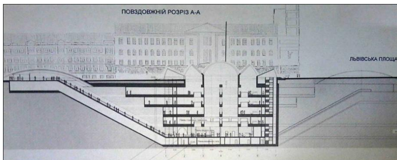
Рис. 5. Поздовжній розріз проміжного вестибюля з ТРЦ
