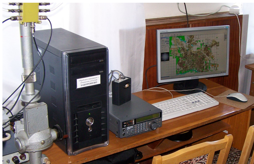
Рис. 7. Мобільний амплітудно-різницевий радіопеленгатор діапазону частот цивільної авіації, обладнаний розробленою антенною системою
