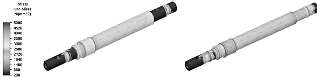
Рис. 4. Розрахунок крутного моменту вхідного та вихідного валів за середніх значеннях параметрів
