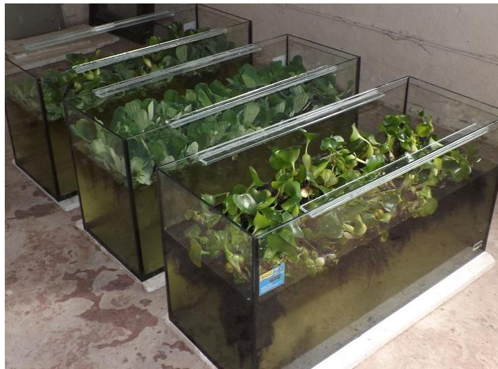
Рис. 1. Модельні системи гідрофітного очищення в умовах КП «Житомирводоканал»
