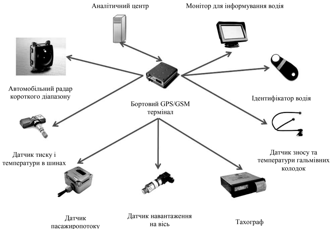
Рис. 1. Схема системи он-лайн моніторингу колісного пасажирського транспорту
