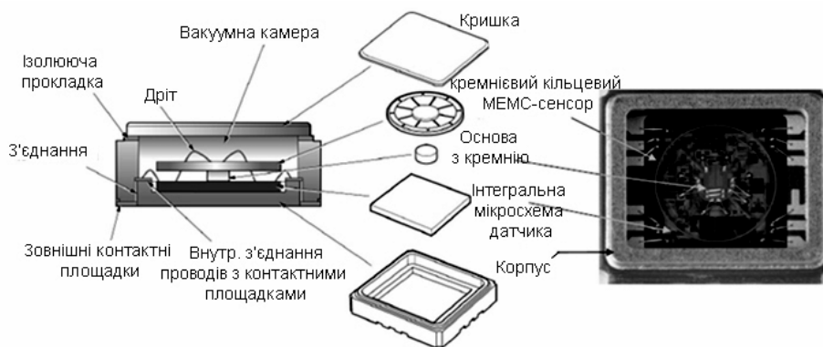
Рис. 6. Схема гіроскопічного гравіметра
