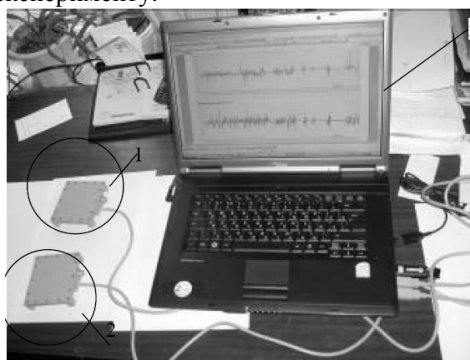
Рис. 4. Мобільний вимірювальний комплекс, розроблений кафедрою технології машинобудування і ремонту машин ХНАДУ: 1, 2 – акселерометри; 3 – ноутбук
