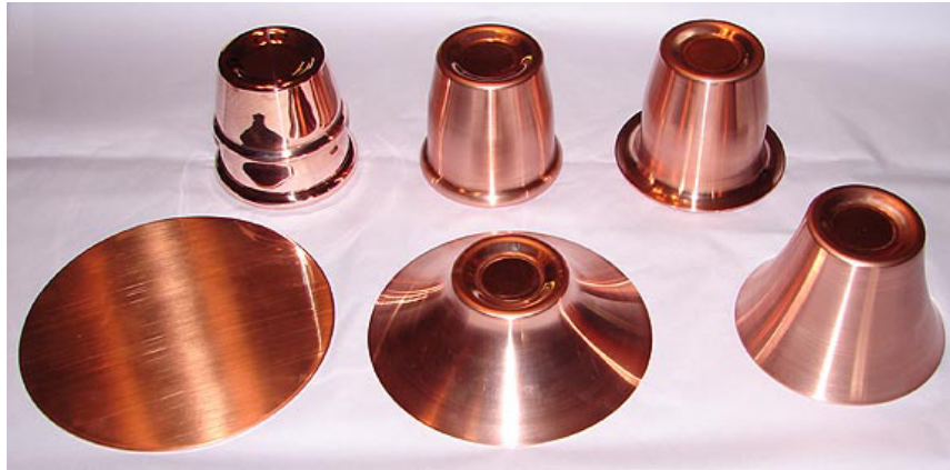
Рис. 5. Деталі, що виготовляються ротаційною витяжкою
